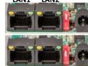
Допускается подключать нагрузку на LAN2 с постоянным потреблением тока 1А и кратковременно 1.5А.
