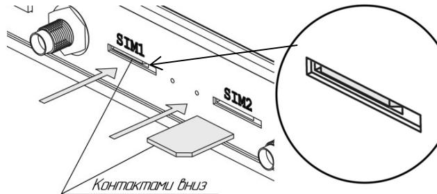
Установку SIM-карты в слот необходимо производить с небольшим усилием, дальше передней панели роутера до характерного щелчка. **Не допускается использование острых предметов (игла, пинцет и т. д.) для установки SIM-карты, в виду возможной деформации разъёма.**
